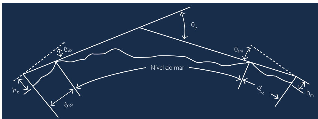
Figura 10. Decomposição de um trajeto hipotético entre transmissor e receptor pelo modelo ITM
